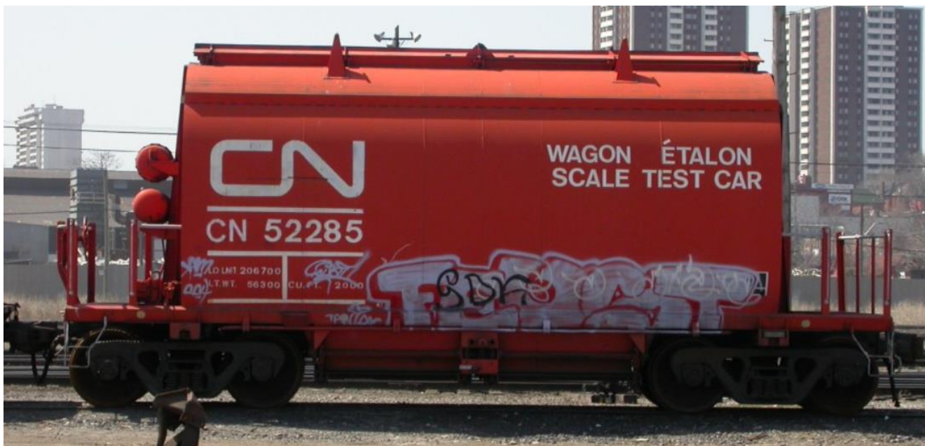
Рисунок 14 – Етоланний вагон виробництва США
