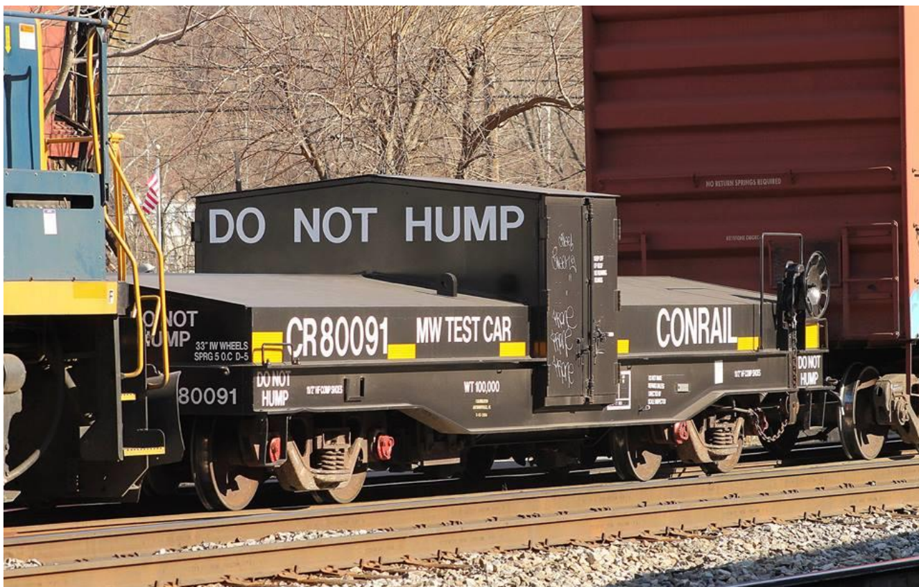
Рисунок 13 – Вагон вагоповірочний ( еталонний) CSX Local B770-17
