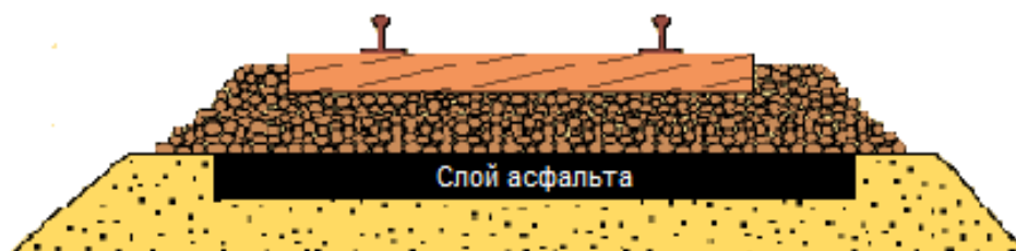
Рис. 1.2. Схема конструкции пути со слоем асфальта
