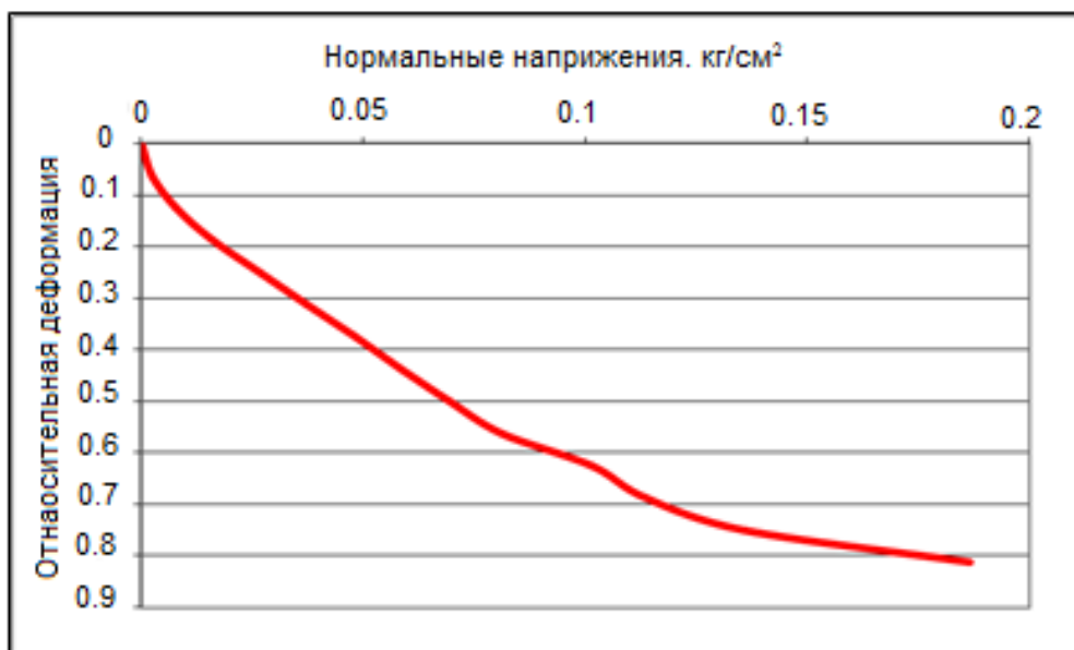
Рис.2.5 Зависимость «нормальное напряжение – относительная деформация» при разрушении образца с геотекстилем в виде объемной георешетки
