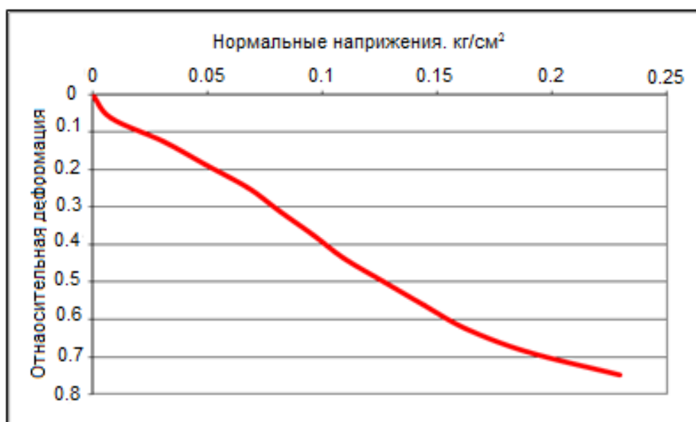
Рис. 2.6 Зависимость «нормальное напряжение – относительная деформация» при разрушении образца с геотекстилем в виде пластины
