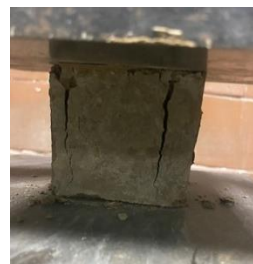
Рис. 6. Підсилення ґрунтоцементу фіброю: a – зразки із базальтовою і поліпропіленовою фіброю; б – пластичне руйнування зразків із додаванням фібри; в – структура фіброґрунтоцементу
