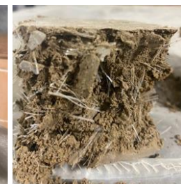
Рис. 6. Підсилення ґрунтоцементу фіброю: a – зразки із базальтовою і поліпропіленовою фіброю; б – пластичне руйнування зразків із додаванням фібри; в – структура фіброґрунтоцементу
