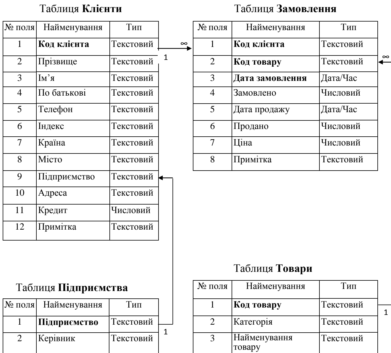
Рисунок 8 – Схема бази даних «Замовлення» у третій нормальній формі
