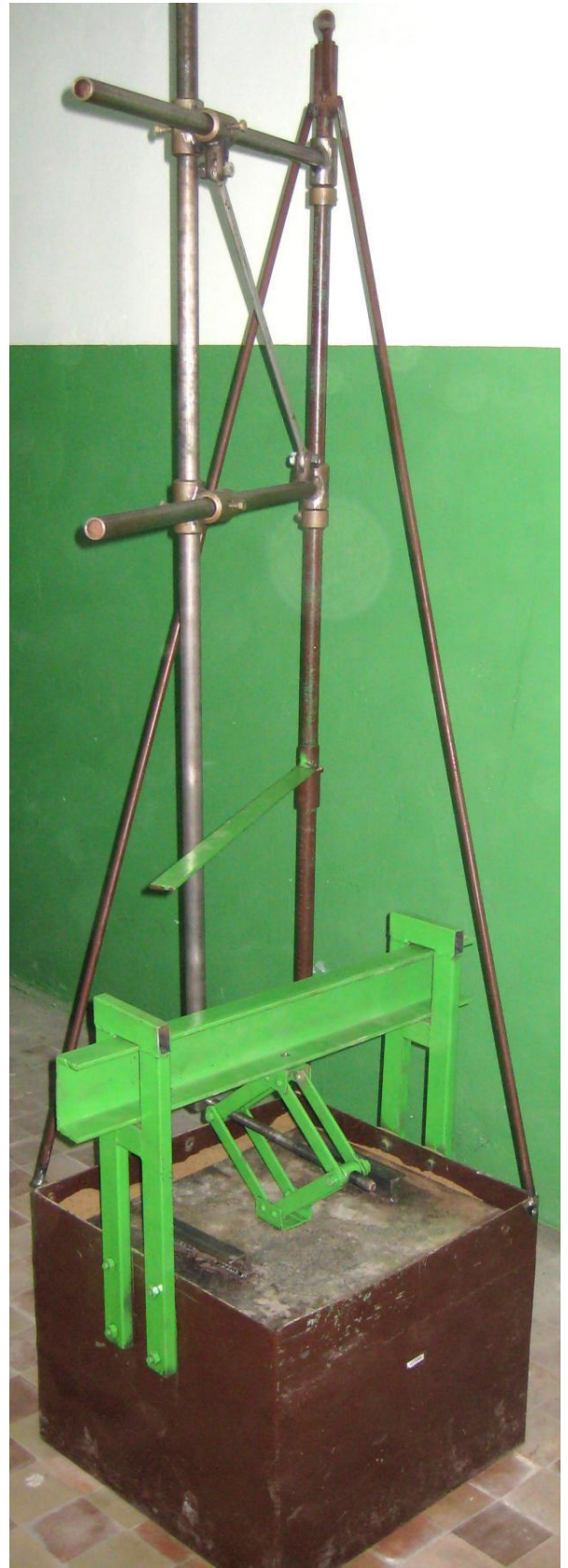
Рис.6.3. Стенд для дослідження процесів утворення ТПГ у ґрунті
