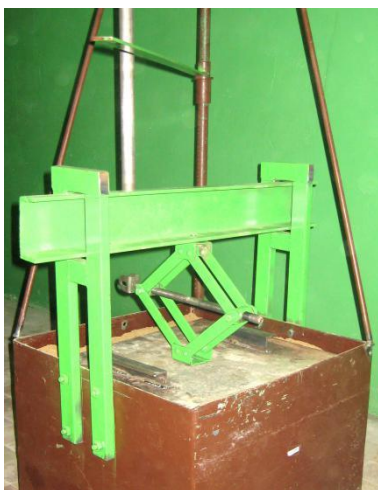
Попереднє ущільнення моделі ґрунту
