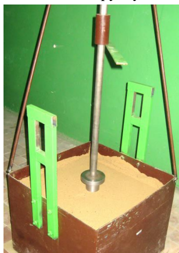
Встановлення на ґрунт фізичної моделі
