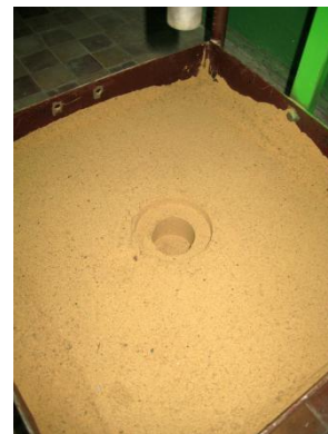
Технологічна порожнина, утворена у ґрунті
