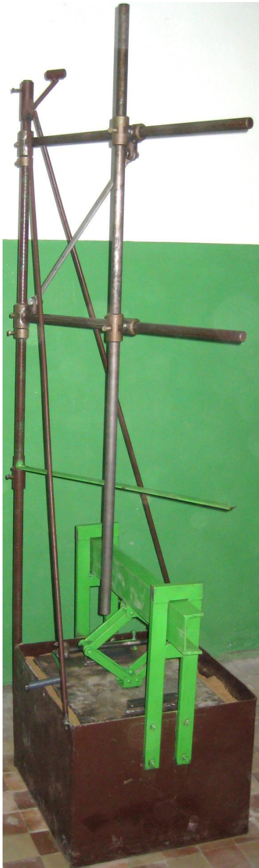
Рис.6.3. Стенд для дослідження процесів утворення ТПГ у ґрунті
