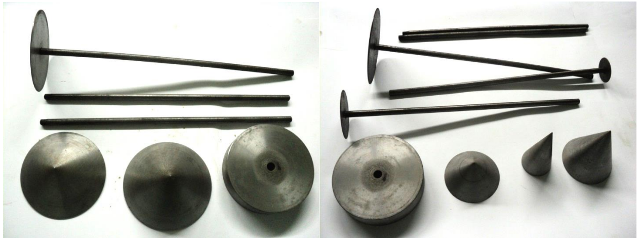
Рис. 7.3. Елементи фізичних моделей циліндрично-конічних РО для утворення ТПГ (масштаб 1:20)
