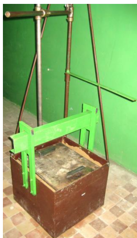
Зняття попереднього привантаження ґрунту
