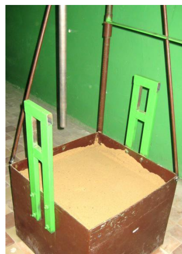
Підготовлена площадка ущільненого ґрунту
