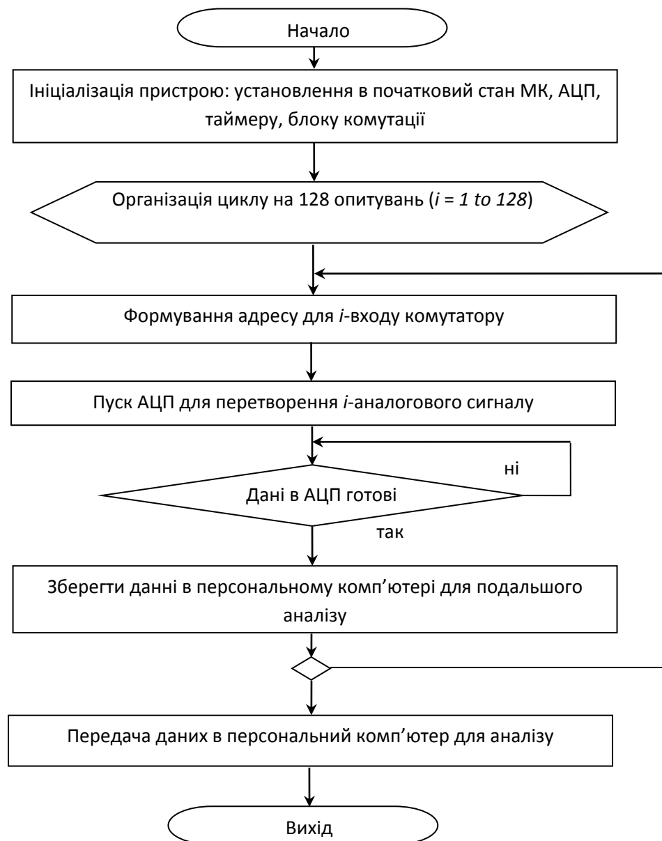
Рис. 3.4 - Алгоритм роботи пристрою управління мікроконтролером PIC16F874
