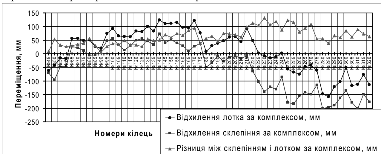
Рис. 10. Результати інструментальних досліджень переміщень точок оправи (склепіння) за комплексом
