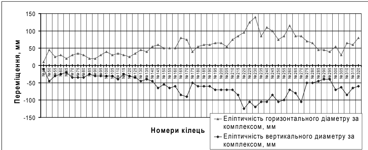
Рис. 11. Результати інструментальних досліджень еліптичностей за комплексом
