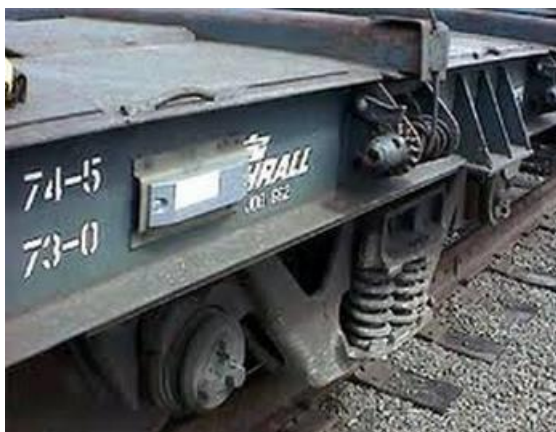
Рис.1.8. Автоматична ідентифікація вагонів по RFID мітках
