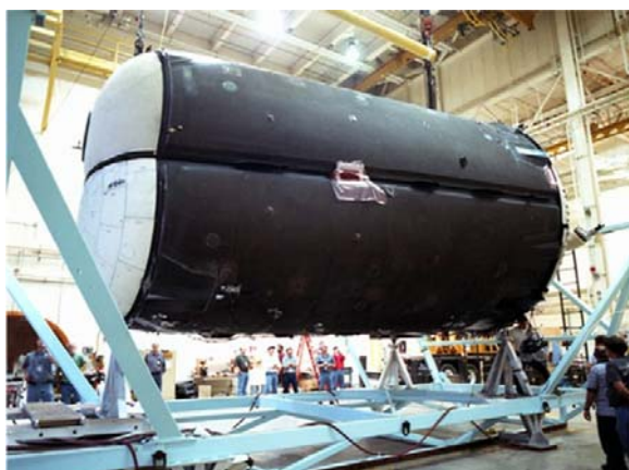
Рисунок 2. Композитный топливный бак X-33 слева и X-34 справа
