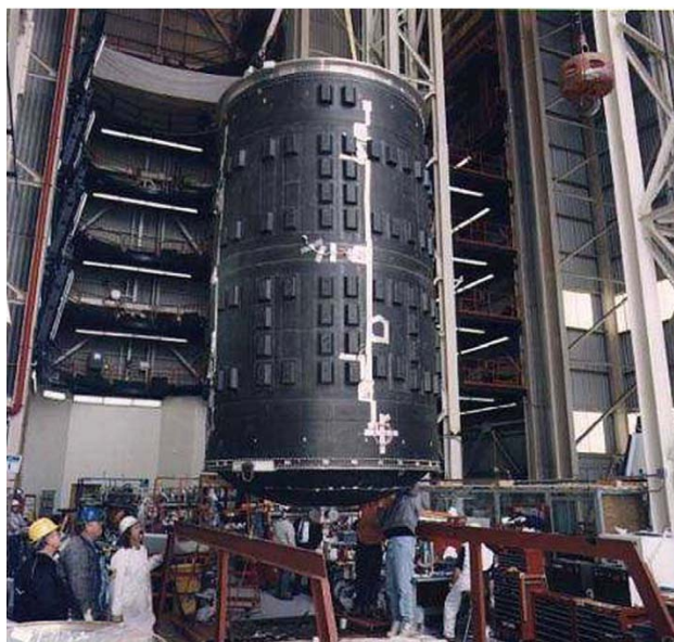
Рисунок 1. Композитный топливный бак DC-XA для жидкого водорода компании McDonnell Douglas
