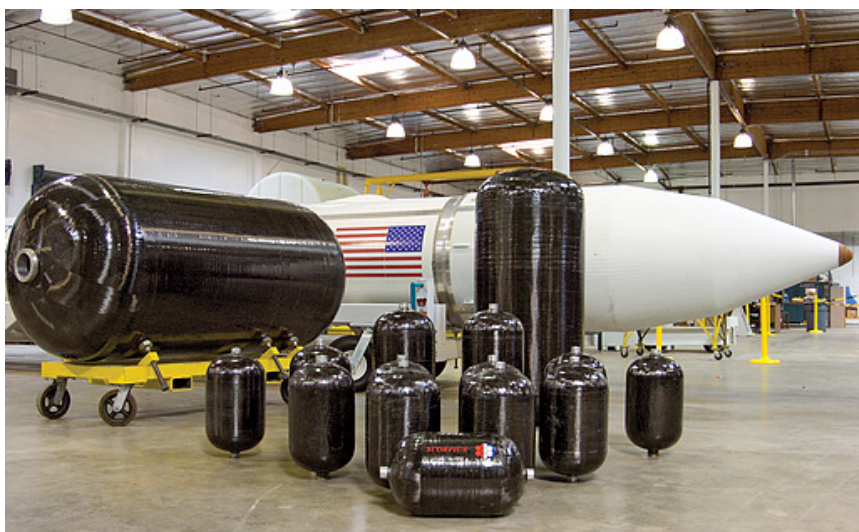
Рисунок 5. Цельнокомпозитные криогенные топливные баки созданные по заказу компании Scorpius Space Launch Company
