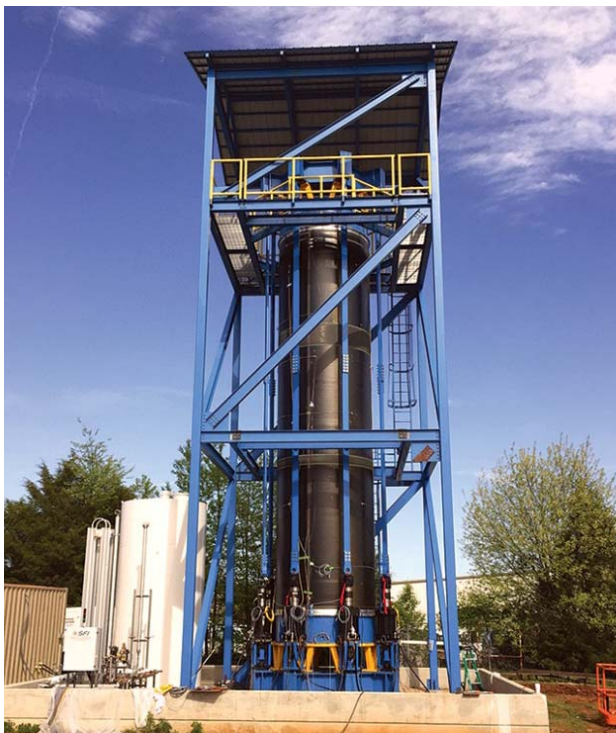
Рисунок 3. Композитный топливный бак компании Norton Gruman для хранения жидкого кислорода или переохлажденного керосина
