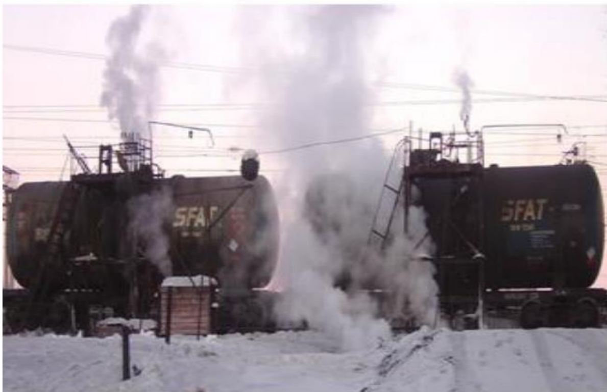
Рис.2.7. Пропарочний пункт станції
