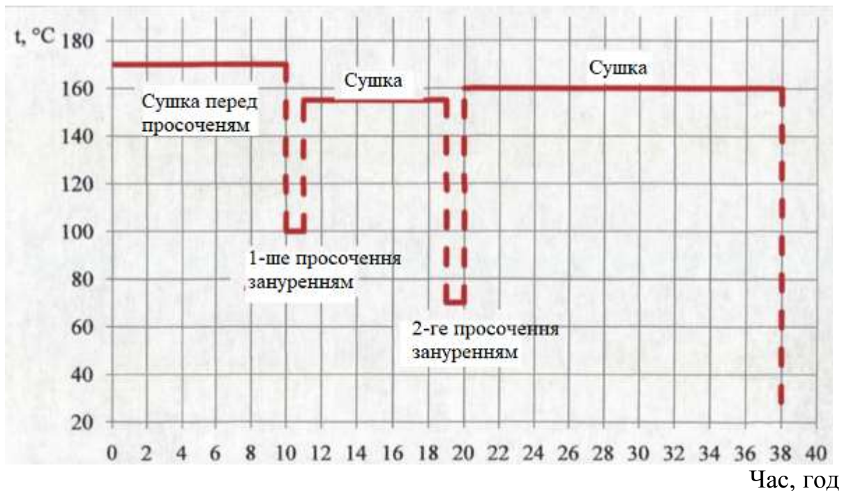
Рисунок 1.4 – Діаграма сушки, просочення і термообробки вузлів ТЕД, просочених в лаку ФЛ-98
