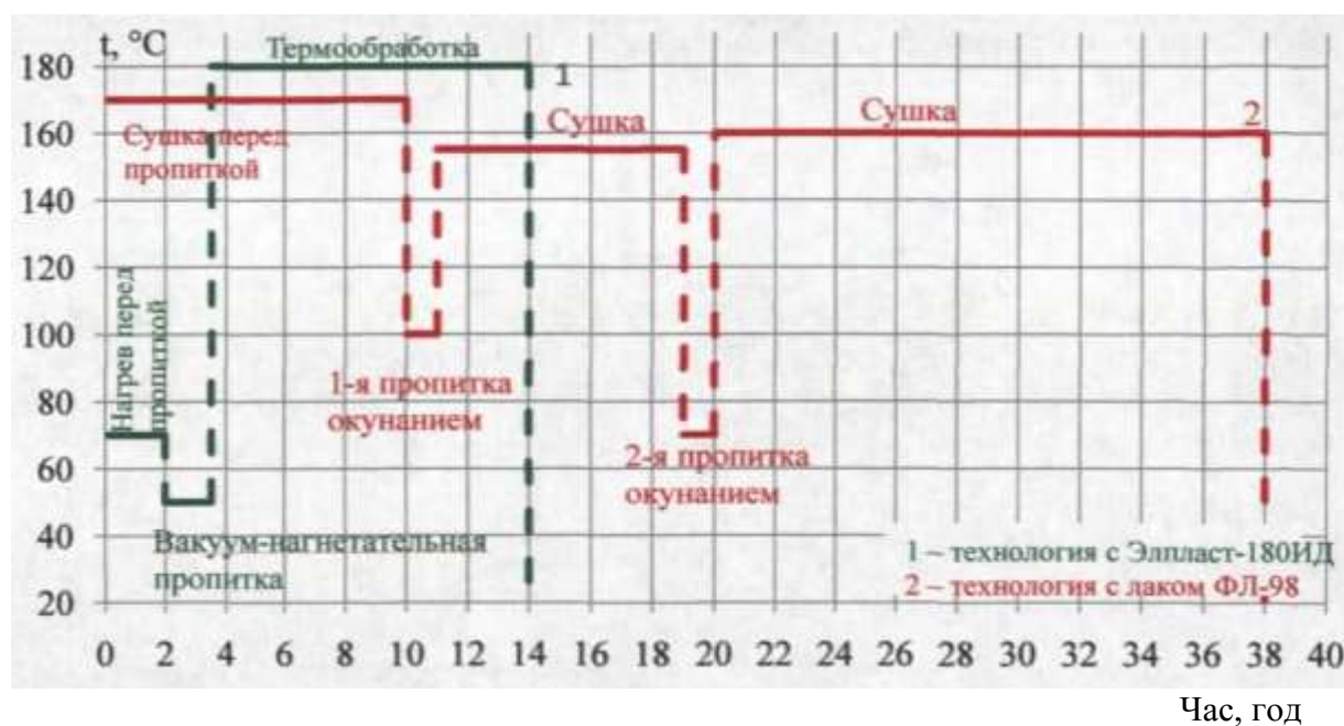
Рисунок 3.9 – Діаграма сушки, просочення та термообробки вузлів ТЕД просочених в компаунді Елпласт-180ІД в порівняння з лаком ФЛ-98
