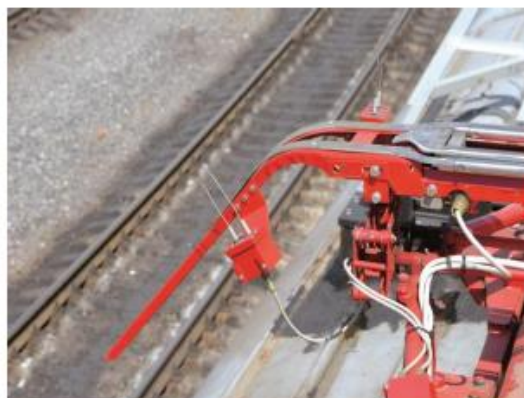
Рисунок 1.7 – Загальний вид вимірювального струмоприймача (а) та датчики, які розміщені на полозі (б)
