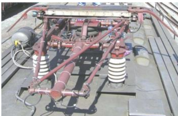
Рисунок 1.7 – Загальний вид вимірювального струмоприймача (а) та датчики, які розміщені на полозі (б)
