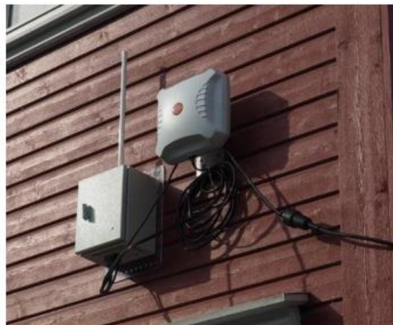
Рисунок 1.14 – Безпроводні датчики (а) та блок прийому (б)
