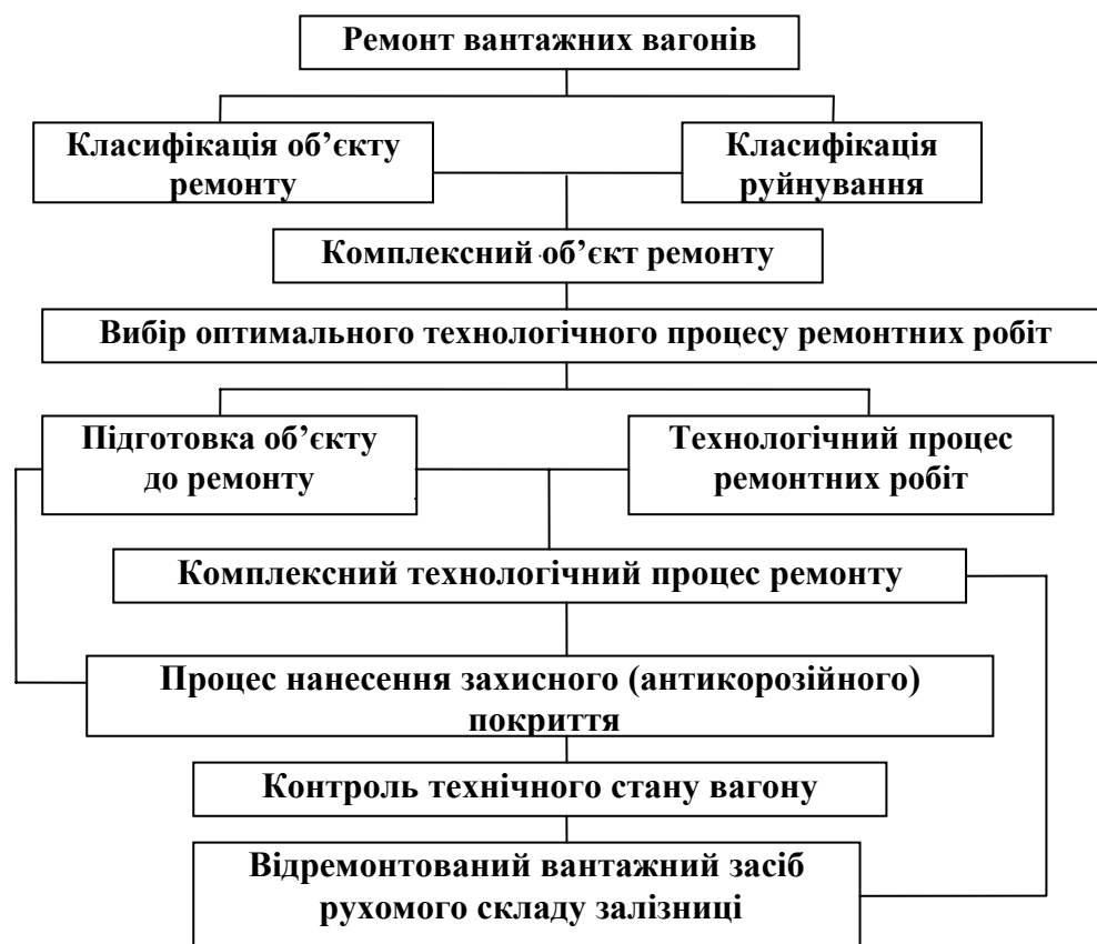
Рис. 1. Схема маршруту технологічного процесу ремонтних робіт вантажних вагонів.
