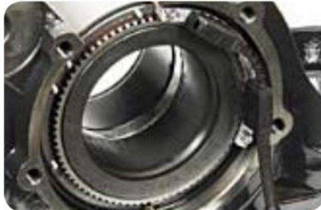
Рисунок 4.15 – Датчик швидкості SKF Axletronic з подвійною головкою для автоматичного керування поїздами (АТС) і ETCS
