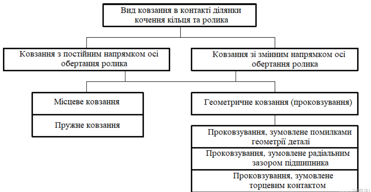
Рисунок 2.2 – Види ковзання на поверхнях кочення кілець буксових роликотидшипників
