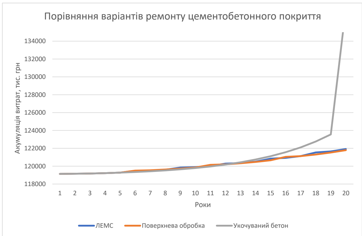
Рисунок 3.1 – Діаграма порівняння акумуляційних витрат трьох видів ремонту цементобетонного покриття
