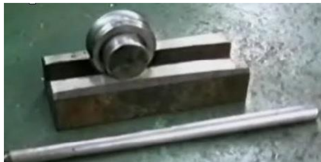
Рисунок 1.5 – Зовнішній вигляд інструмента стана ХПТР
