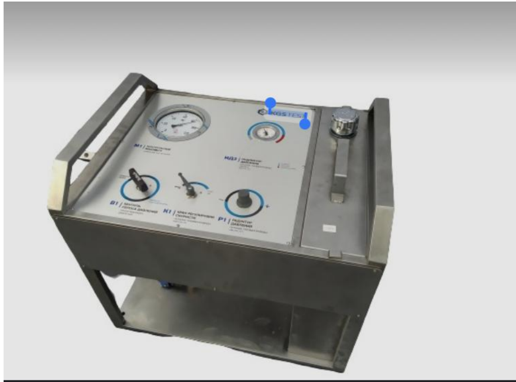
Рисунок 4.15. Пульт управління гідравлічними випробуваннями, що виконуються на стенді-кантивача №3
