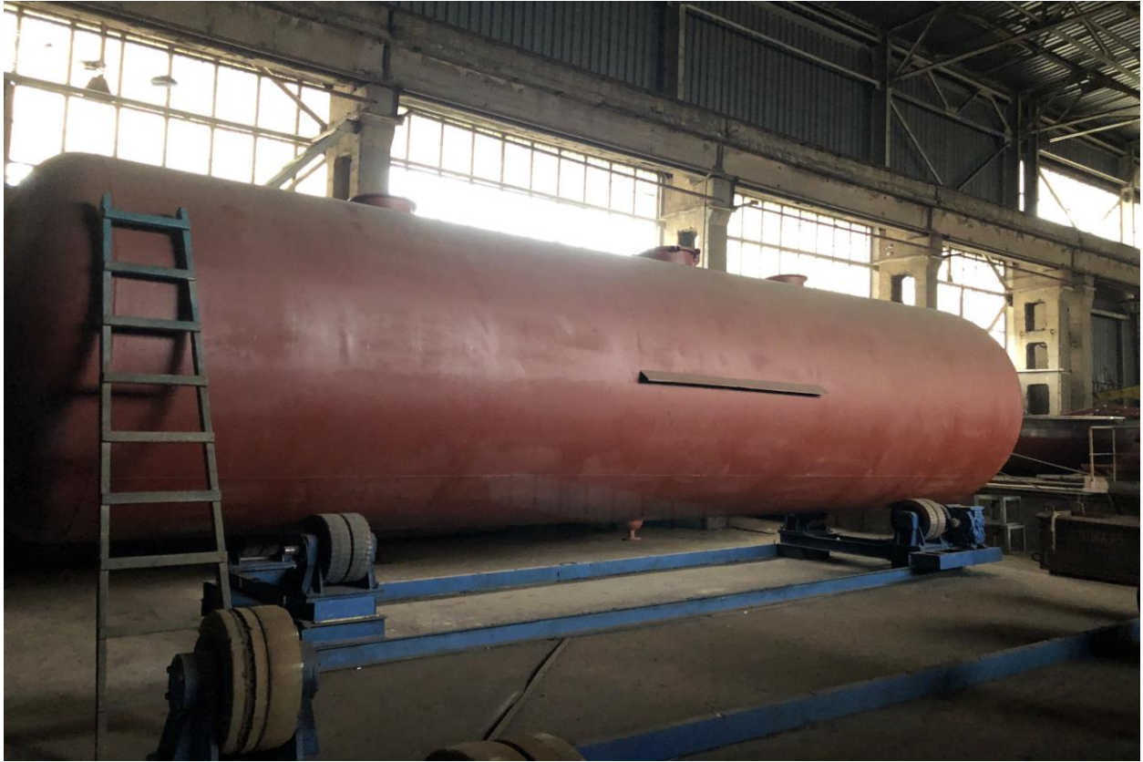
Рисунок 4.16. Котел, що пройшов остаточні випробування на стенді-кантовачі №3.
