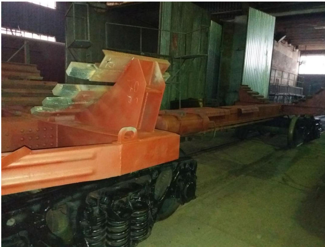
Рисунок 4.4. Рама термоцистерни із демонтованим котлом.
