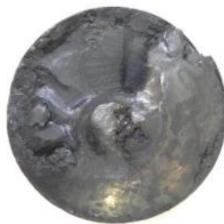
Рисунок 1.9 – Внутрішній дефект у осі, виявлений ультразвуковим методом
