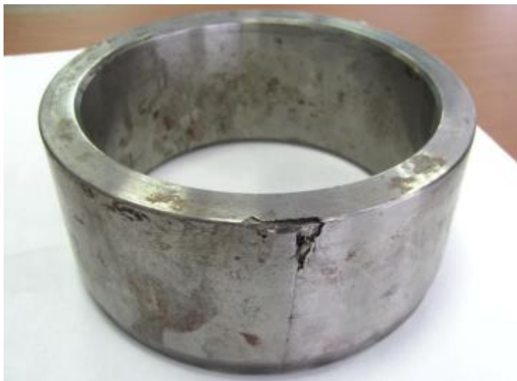
Рисунок 1.2 – Зовнішній дефект внутрішнього кільця буксового підшипника вузла, виявлений за допомогою візуального контролю
