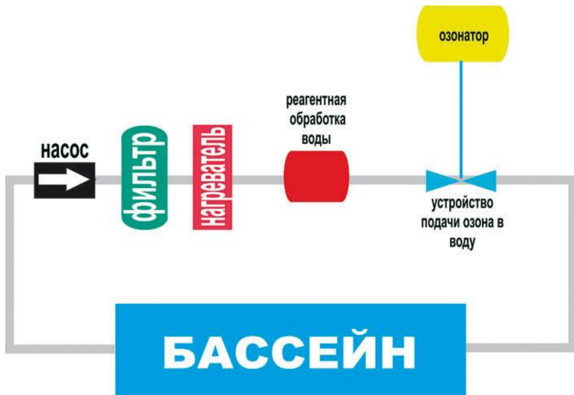
Рисунок 4.4 - Приклад схеми озонування води в басейні
