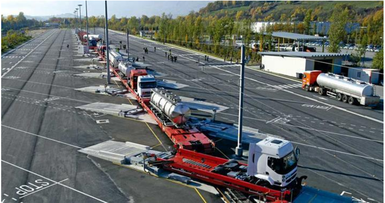
Рисунок 2.7 – Контрейлерный терминал Modalohr
