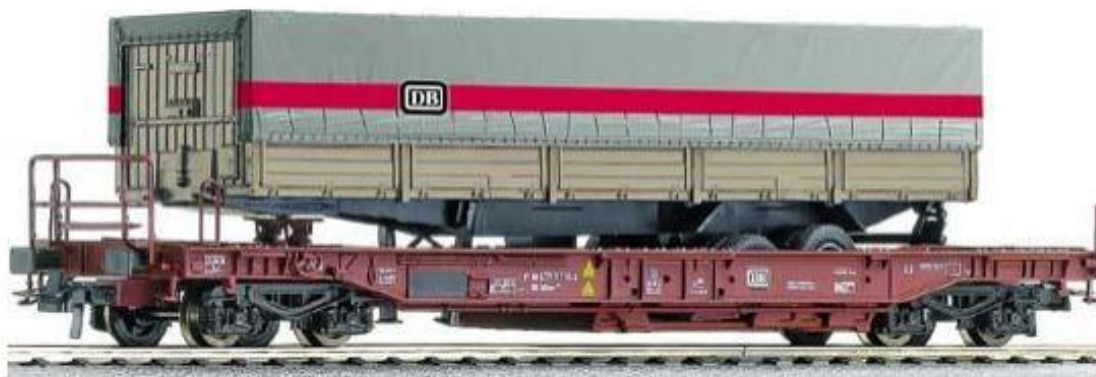
Рисунок 2.12 – Универсальная платформа, используемая в технологии Lo-Lo
