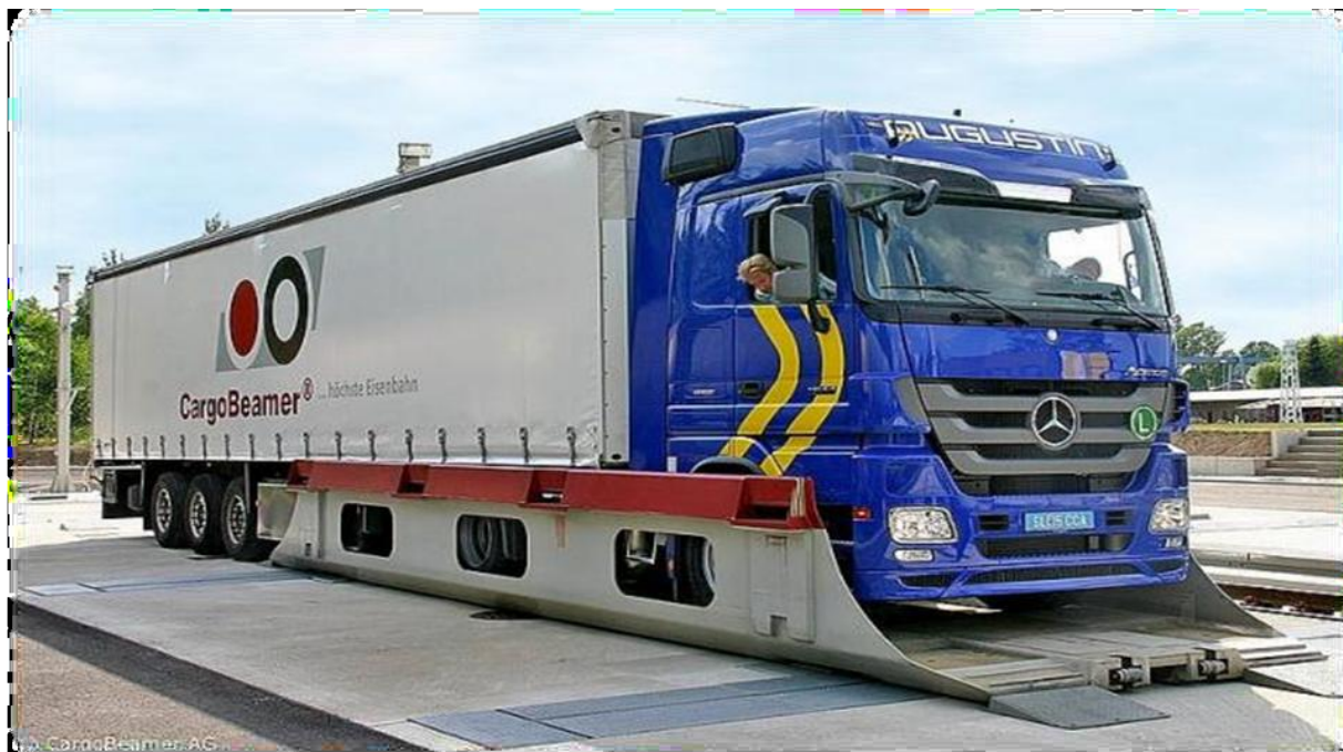
Рисунок 2.1 – Заезд тягача с полуприцепом на передвижную часть платформы
