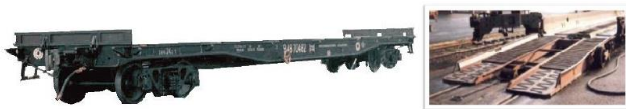
Рисунок 3.3 – Подвижной состав (модель 13-9004М «Днепровагонмаш»)
