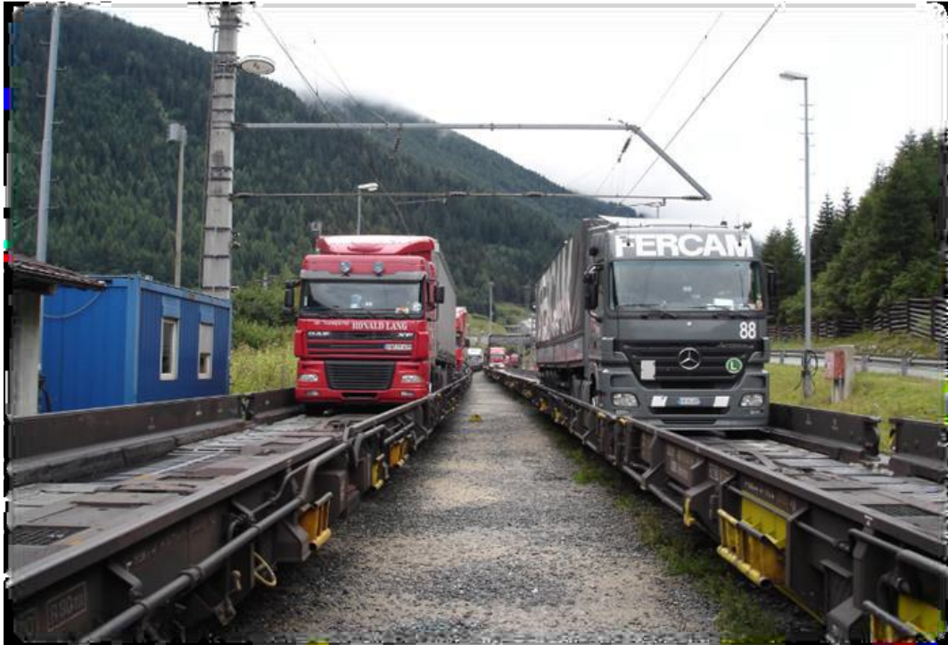
Рисунок 2.10 – погрузка по технологит «Бегущее шоссе».
