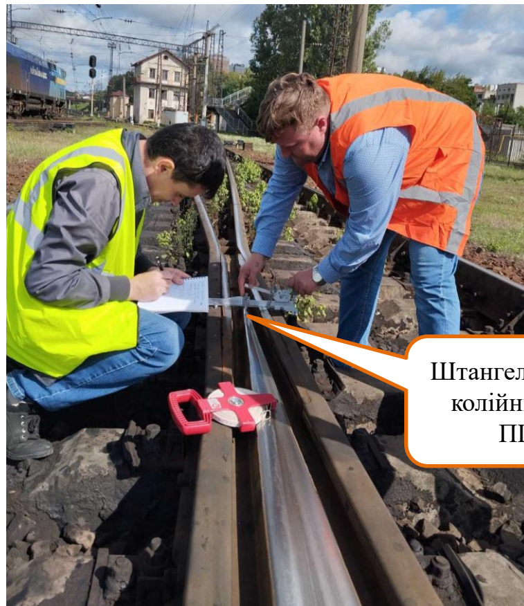
Рисунок 3.4 – Вимірювання вертикального зносу хрестовини із застосування штангельциркулем колійник
