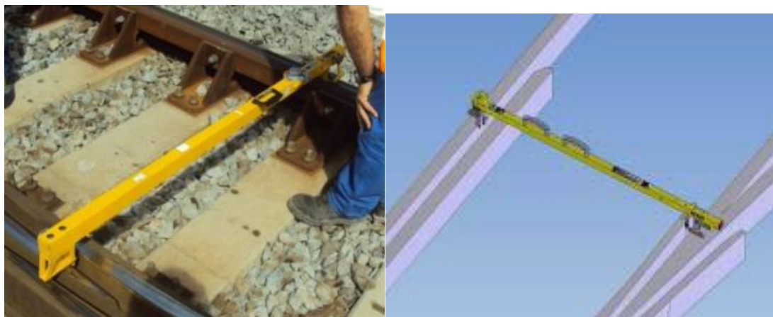
Рисунок 2.8 – Вигляд системи S&C measuring trolley –FELIX
