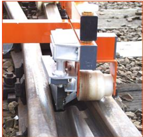
Рисунок 1.11 – діагностика хрестовин стрілочних переводів із використанням пристроїв неперервної діагностики
