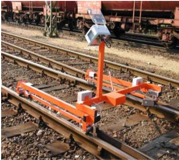
Рисунок 1.11 – діагностика хрестовин стрілочних переводів із використанням пристроїв неперервної діагностики
