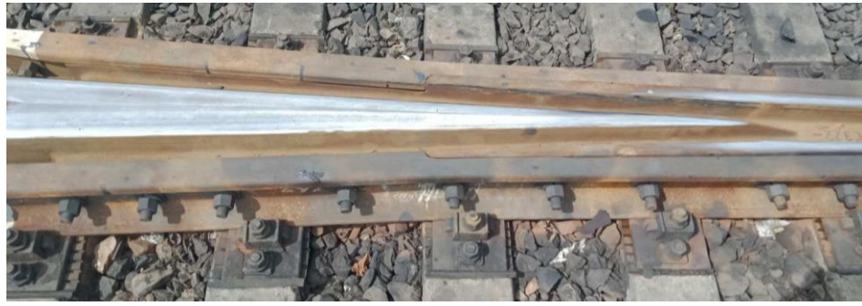
Рисунок 3.3 – Конструкція досліджувальної хрестовини
