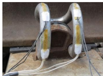
Рис. 1. Схема встановлення датчиків на клеми типу КП-5 проміжного рейкового скріплення типу КПП-5
