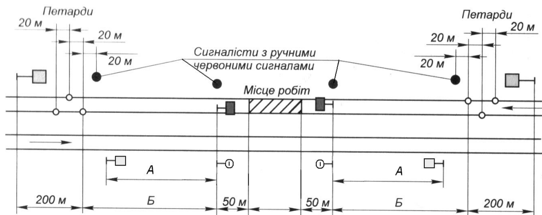
Рисунок 5.1 – Схема огороження місця робіт на двоколінійній ділянці з розгорнутим фронтом робіт більше 200 м.
