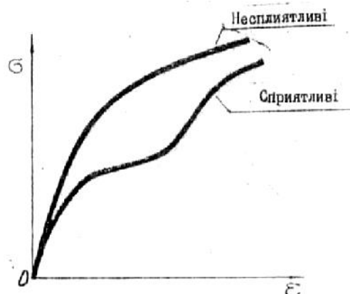
Рис. 1.8. Криві зміцнення для ГЦК- і ОЦК-металів
