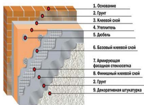
Рис. 6. Утеплення фасаду штукатуркою «короїд»
