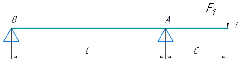
Рис. 3.4 Схема навантаження важеля 3
