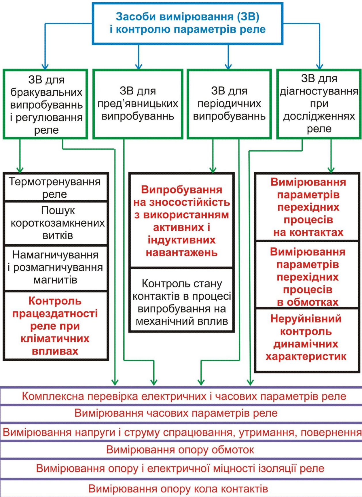
Рисунок 1.3 - Класифікація КВА для виробництва та досліджень реле
