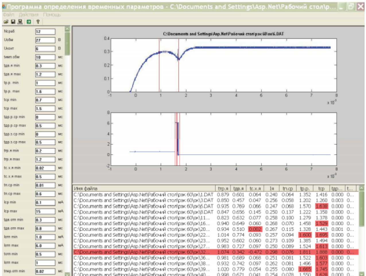
Рисунок 3.7 - Головне вікно програми, що містить розгорнуті осцилограми і результати розрахунку комплексу динамічних характеристик реле РЕК 60
