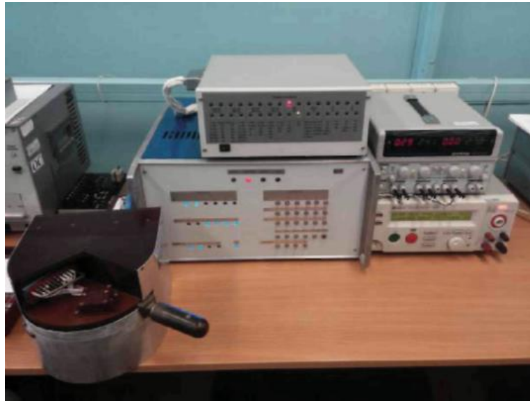
Рисунок 5.17 - Вимірювальна система випробувань електричної ізоляції реле
