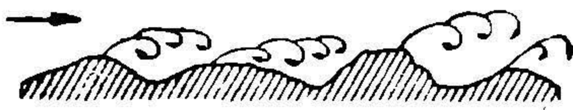
Рис. 13. Образование вихрей у шероховатых стенок.
