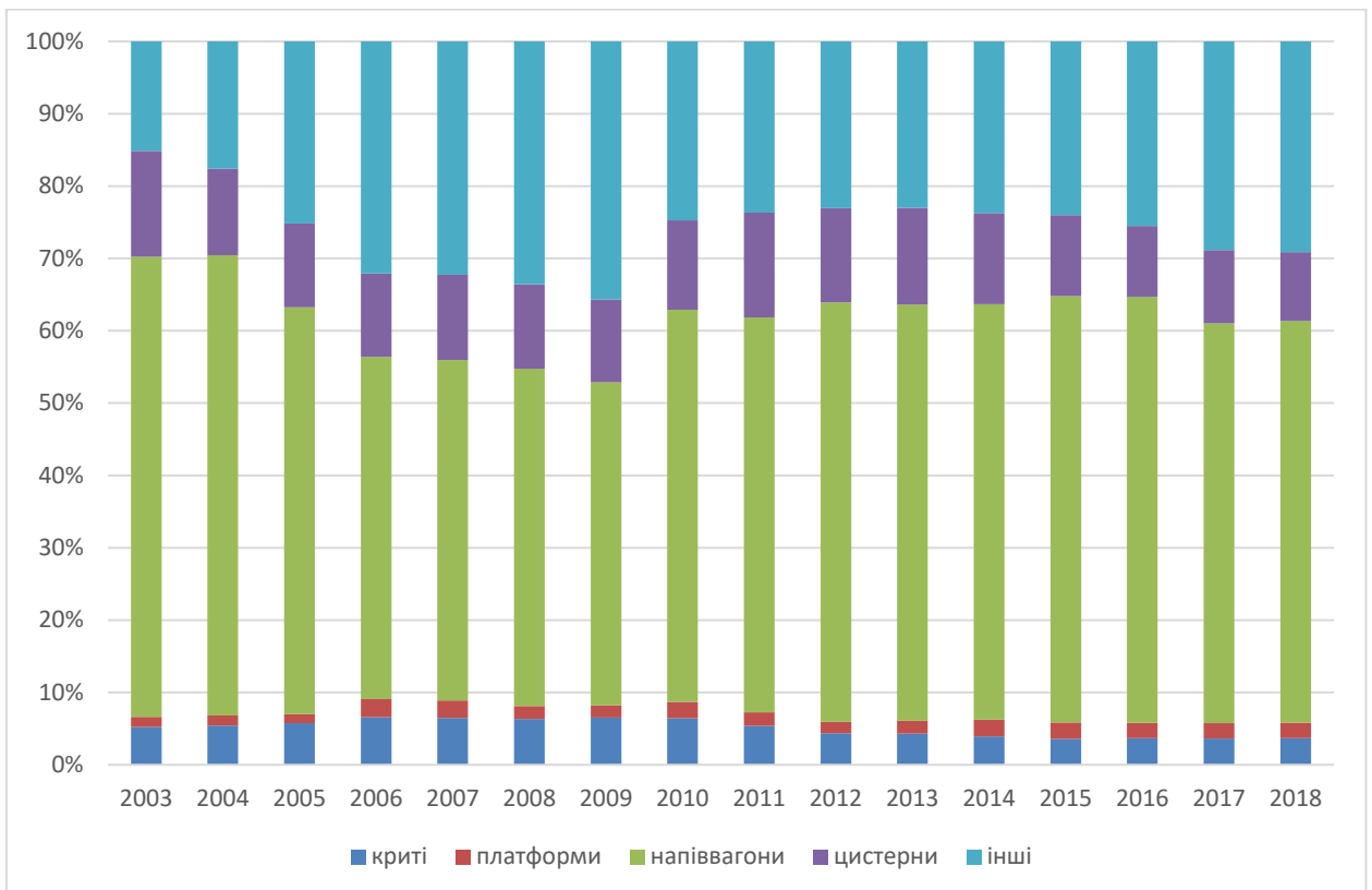
Рис. 2.3 – Зміна структури робочого парку вантажних вагонів у часі, %
