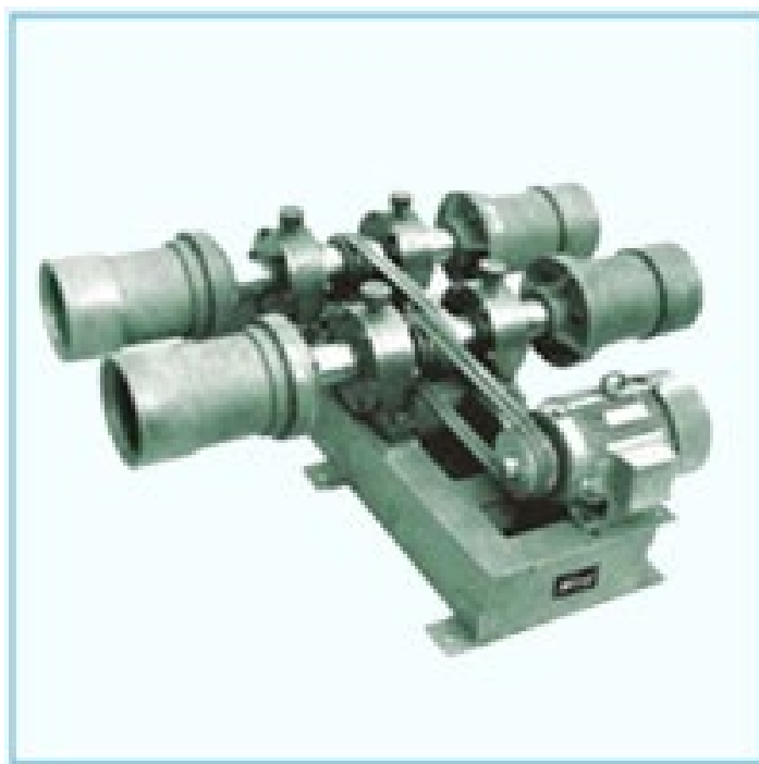
Рис. 1.9. Машина з груповим приводом форм
