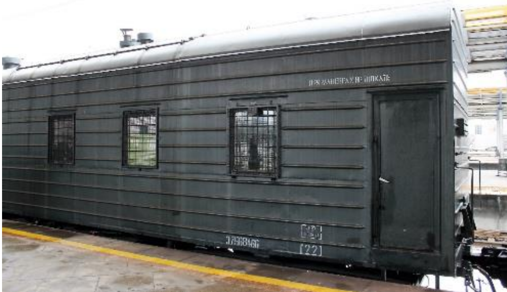
Рис. 91. На всі вікна ВСТП зовні встановлюються металеві ґрати з чарунками.
