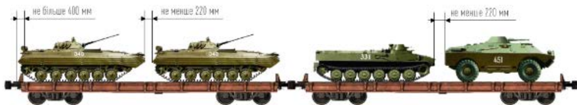
Рис. 53. Відстані між одиницями техніки при закріплення ОВТ за допомогою УМК.
