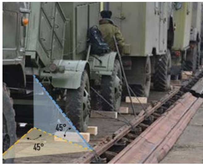
Рис. 62. Кути між розтяжкою і підлогою вагона, між проєкцією розтяжки на підлогу вагона й поздовжньою віссю вагона.
