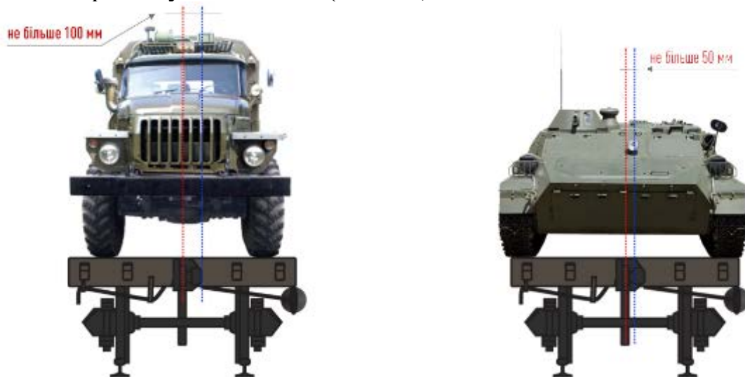
Рис. 51 Поперечне зміщення центру ваги навантаженого ОВТ від вертикальної площини, в якій знаходиться поздовжня вісь вагону.
