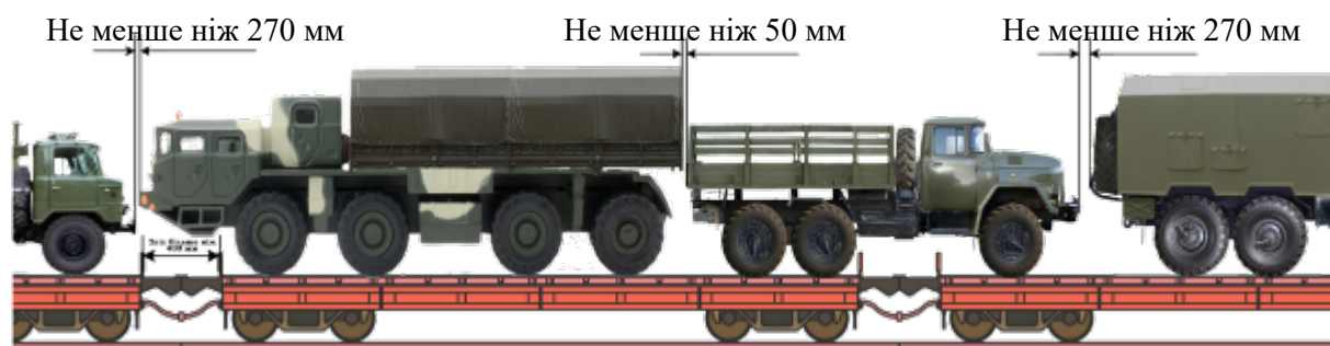
Рис. 48. Варіанти розміщення машин на зчепках платформ.
