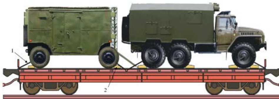
Рис. 78. Закріплення тривісного автомобіля та двовісного причепа за допомогою розтяжок та упорних брусків: 1 – розтяжка; 2 – упорний брусок.
