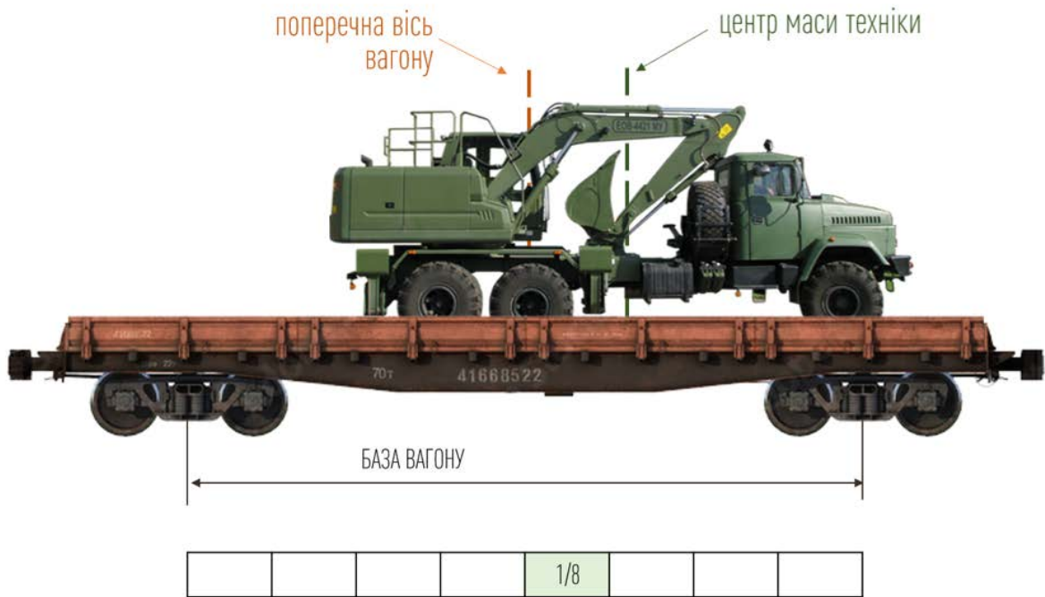
Рис. 50. Зміщення загального центру маси техніки від вертикальної площини, в якій знаходиться поперечна вісь вагону.
