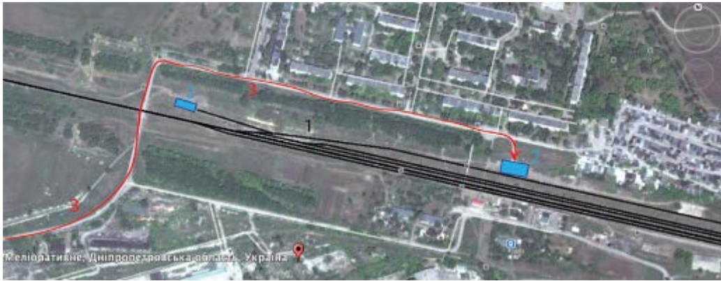
Рис. 41. Основні елементи вантажно-розвантажувального місця (1 – залізничні колії, 2 – вантажно-розвантажувальні пристрої, 3 – автодорога).
