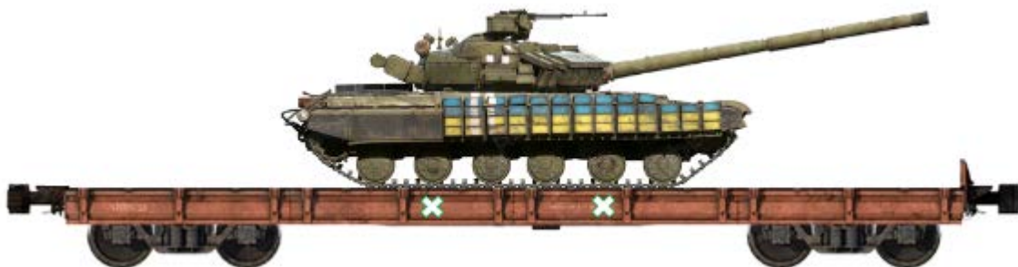
Рис. 68. Закріплення ВГМ за допомогою УМК-2Г.
