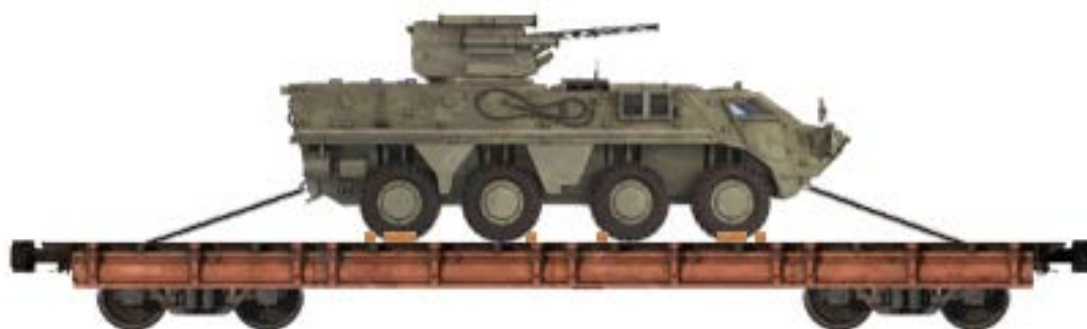
Рис. 79. Закріплення БТР-4Е за допомогою розтяжок та брусків.
