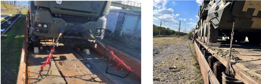
Рис. 57. Закріплення колісної техніки за допомогою ланцюгових та дротових розтяжок.
