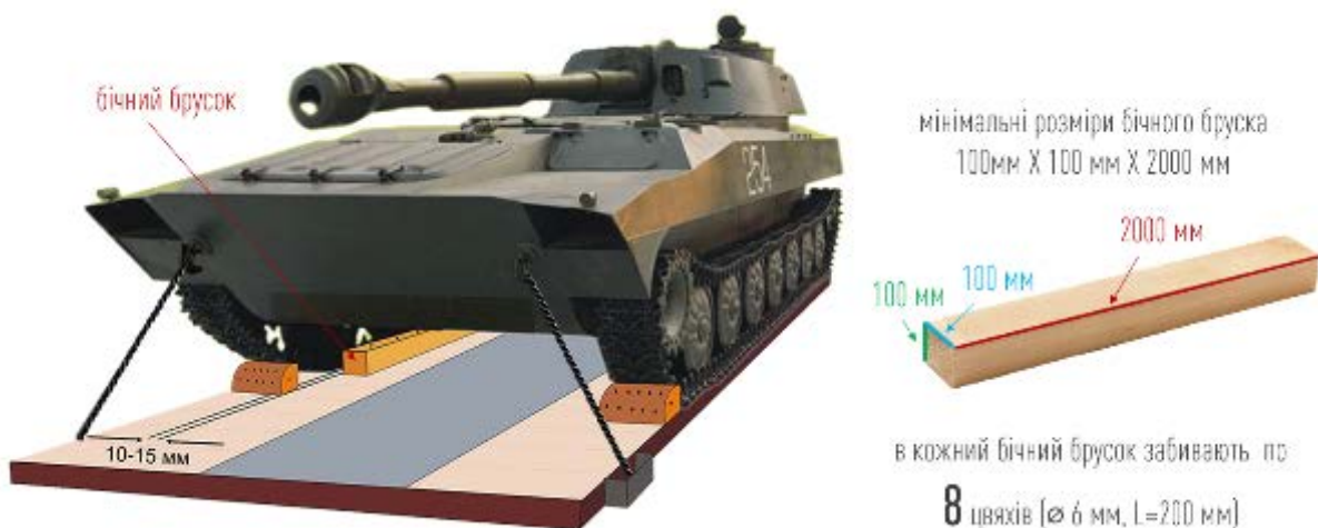
Рис. 71. Закріплення ВГМ від поперечного зсуву бічними брусками.
