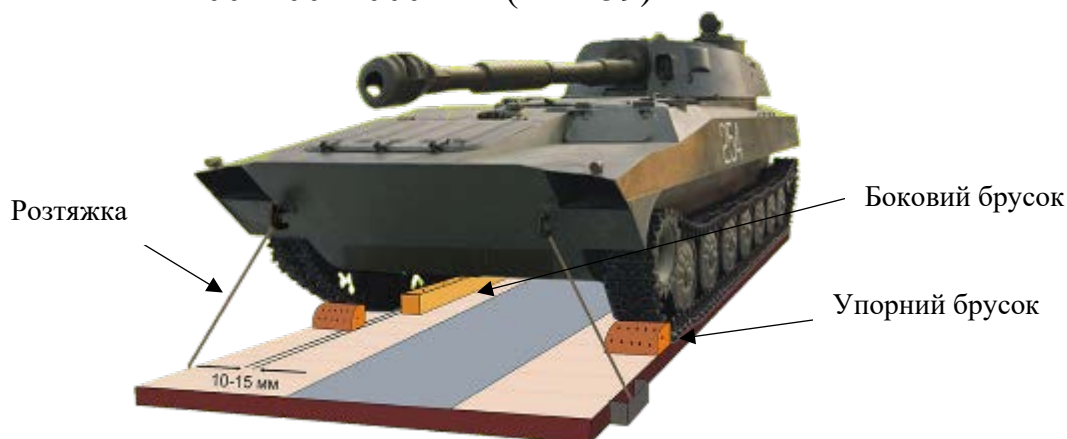
Рис. 59. Закріплення ВГМ за допомогою дерев'яних брусків та дров'яних розтяжок.
