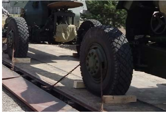
Рис. 58. Закріплення колісної техніки за допомогою дерев'яних брусків та дротяних розтяжок.
