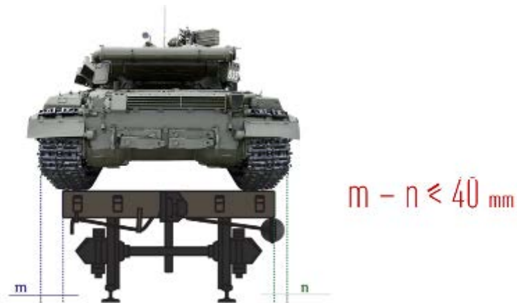
Рис. 52. Допустимі відстані для звисання гусениць танків.
