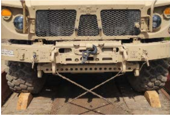
Рис. 58. Закріплення колісної техніки за допомогою дерев'яних брусків та дротяних розтяжок.
