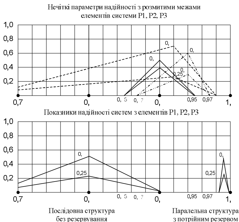
Рисунок 17 - Результати оцінки надійності РІКОС з послідовною структурою і потрійним резервуванням
