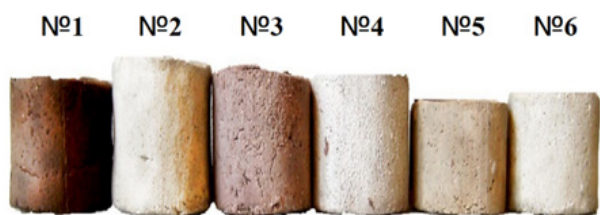
Рис. 5. Зовнішній вигляд зразків пластичних матеріалів що досліджувались, де зразки №1, №3 – імпортного виробництва («еталонні»); №2, №4-№6 – розроблені склади-аналоги
