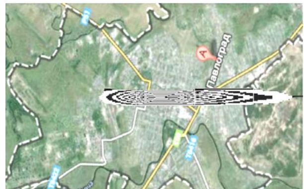
Рис. 8. Зона загрязнения через 21 минуту после начала горения топлива (процесс горения прекратился)
