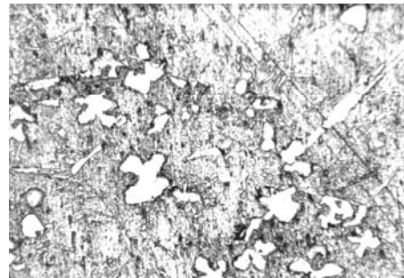
Рис. 1. Зміна морфології залізовмісних інтерметалідів в структурі сплаву АК9М2 під впливом модифікування ( \times 500 ): а – фаза Al_5SiFe ; б – фаза Al_{15}(FeMn)_3Si_2
