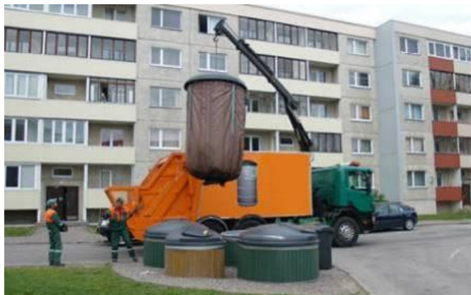
Рис. 2. Розвантаження у смітєвоз мішка з відходами з контейнера заглибленого типу на контейнерному майданчику
