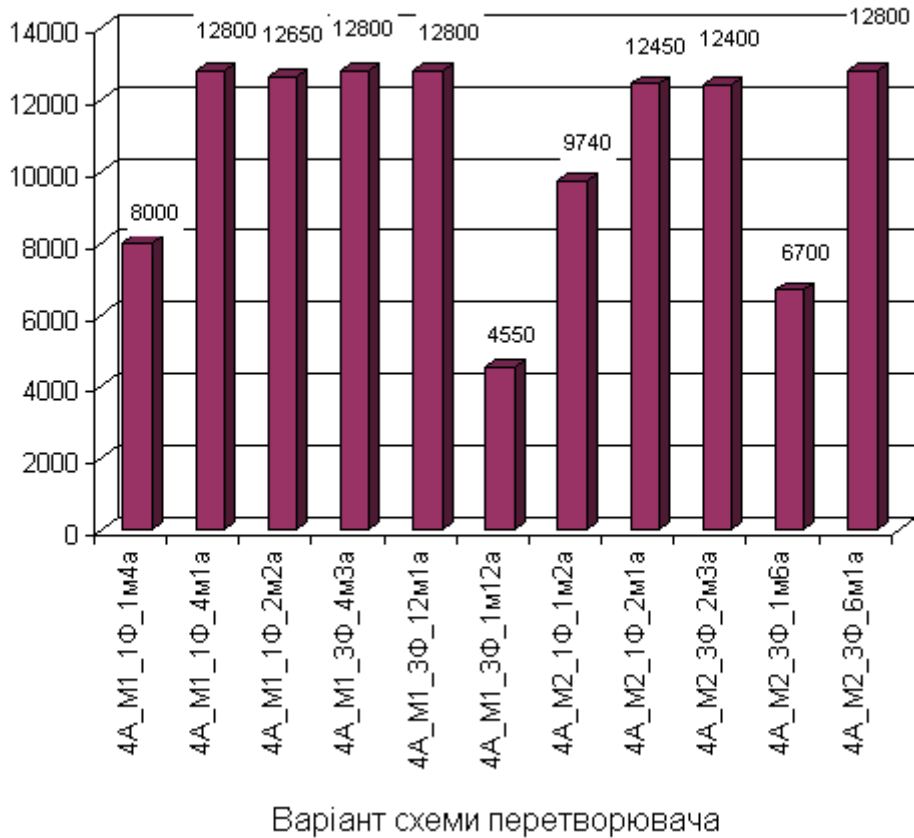
Рис. 2.14. Термін часу досягнення рівня при різних структурних схемах перетворювачів для живлення 4АТД.
