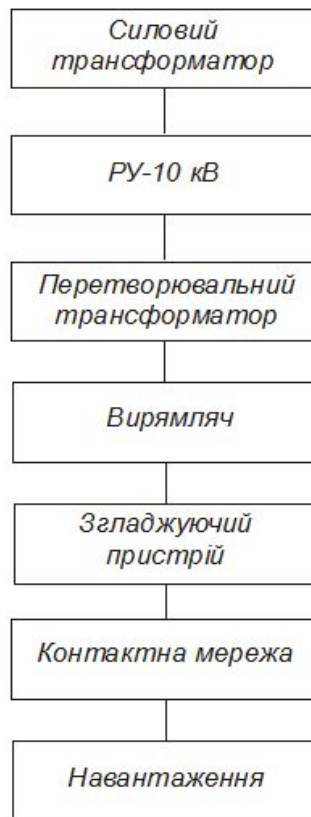
Рисунок 3.4 – Структурна схема тягової підстанції постійного струму
