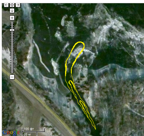
Рисунок 2.10. Зона забруднення акваторії (90 хвилин після аварії)
