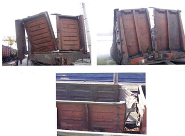
Рисунок 2.2 - Обрив зварного шва з'єднання стійки з обв'язкою або балкою рами
