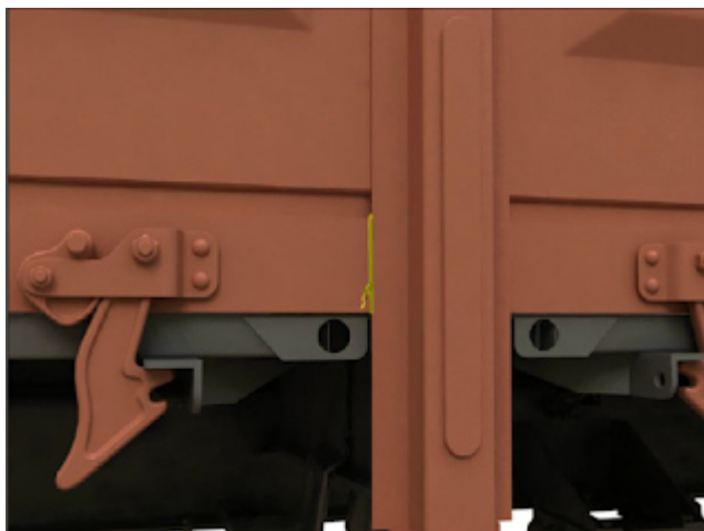
Рисунок 2.2 - Обрив зварного шва з'єднання стійки з обв'язкою або балкою рами
