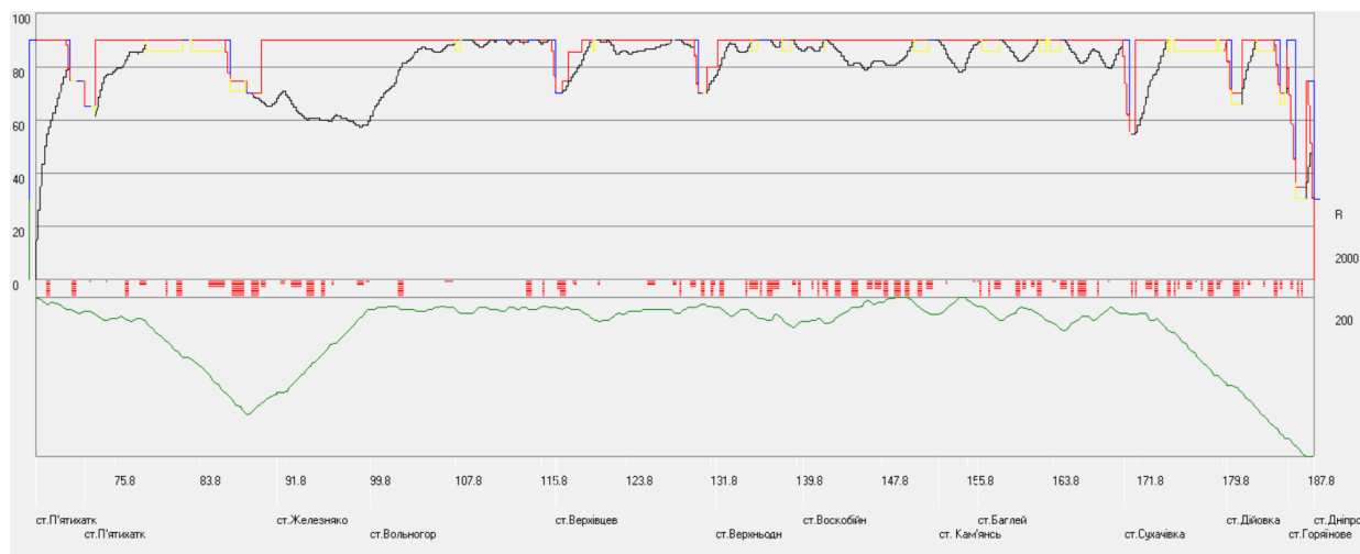
Рисунок 2.8 – Крива швидкості руху, план і поздовжній профіль (П'ятихатки – Дніпро, 4600 т)
