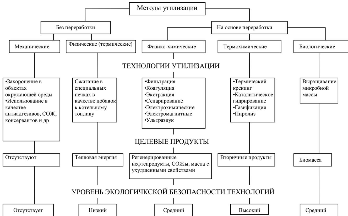
*Рис.59. Методы и технологии утилизации нефтесодержащих отходов и отработанных масел*
