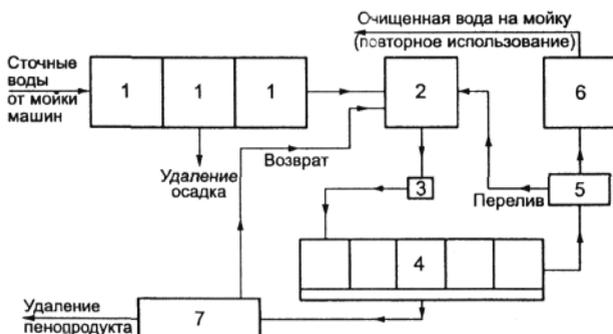
Рис. 33. Принципиальная схема очистки сточных вод после мойки машин.
