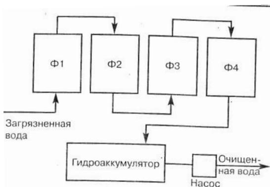
Рис.38. Принципиальная схема единичного БДО
