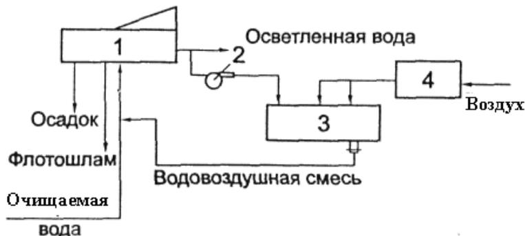
Рис.17. Конструктивная схема установки "Supracell"
