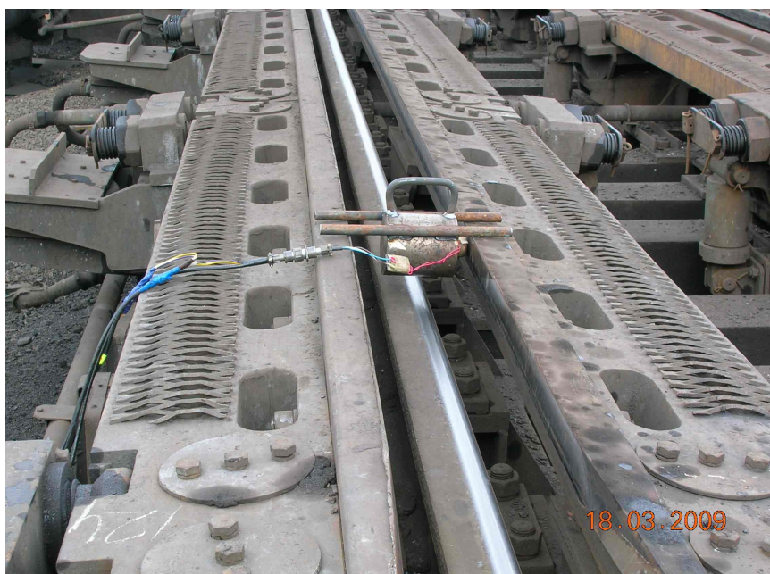
Рис. 7.3. Загальний вигляд металевого вкладиша з месдозою
