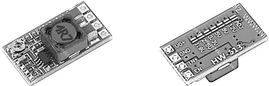
Рисунок 2.9 – Знижувальний перетворювач напруги постійного струму "Міні DC-DC 4.5-24В" на мікросхемі MP2315
