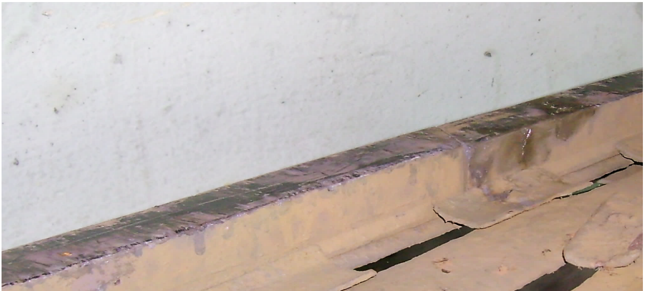
Рисунок 2.3 – Сліди міді на струмознімальній частині вставок
