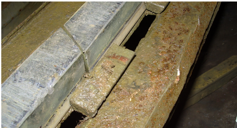
Рисунок 2.20 – Іржа та окалина на полозі струмоприймача
