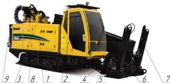
Рис.1.5. Установка ГНБ фірми Vermeer: 1 – силова установка з рамою; 2 – кабіна оператора; 3 – привід бурових штанг; 4 – направляюча рама приводу бурових штанг; 5 – ключі з гідроприводом для розкручування штанг; 6 – магазин штанг; 7 – анкерні пристрої; 8 – ходове обладнання; 9 – pompa подачі бурової рідини
