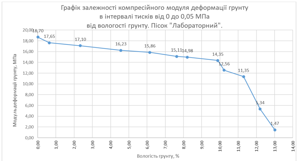
Граф. 3.5. Графік залежності компресійного модуля деформації ґрунту від вологості для піску «лабораторного» в інтервалі тисків від 0,0 до 0,05 МПа.
