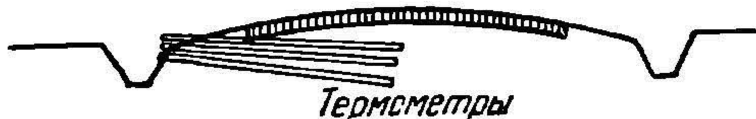
Фиг. 46. Схема установки почвенных термометров в теле полотна дороги.
