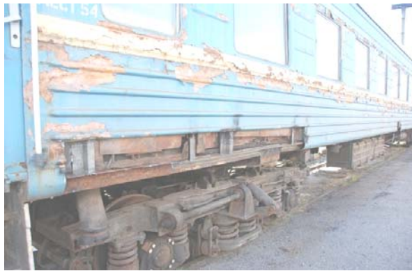
Рис. 2. Розкриття панелі бокової стіни
