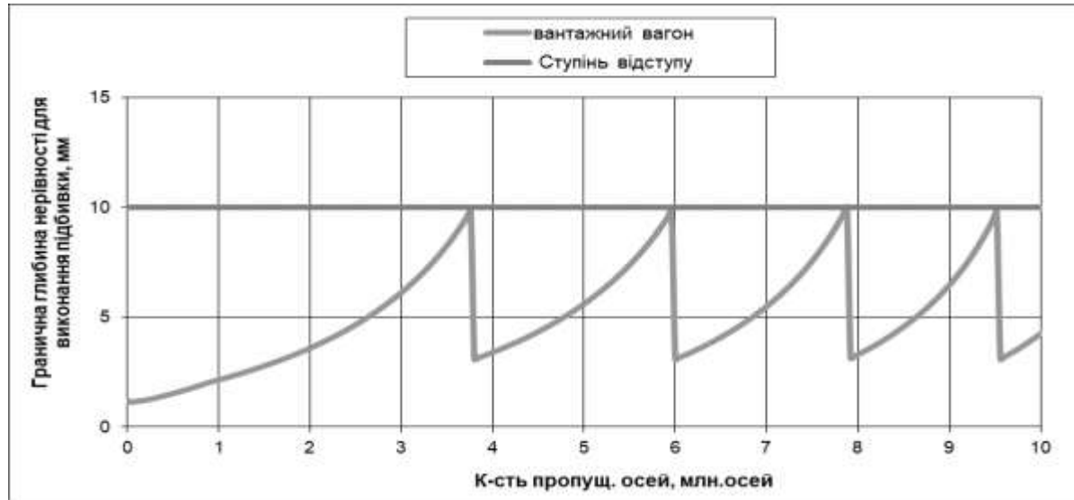
Рисунок Б.1 Розвиток нерівності для вантажного вагона в залежності від кількості пропущених осей [15]
