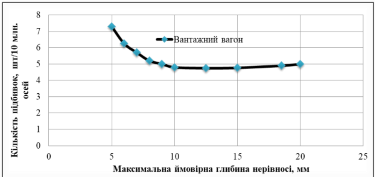
Рисунок 2.5 – Кількість підбивок при різній глибині нерівності для вантажного вагона
