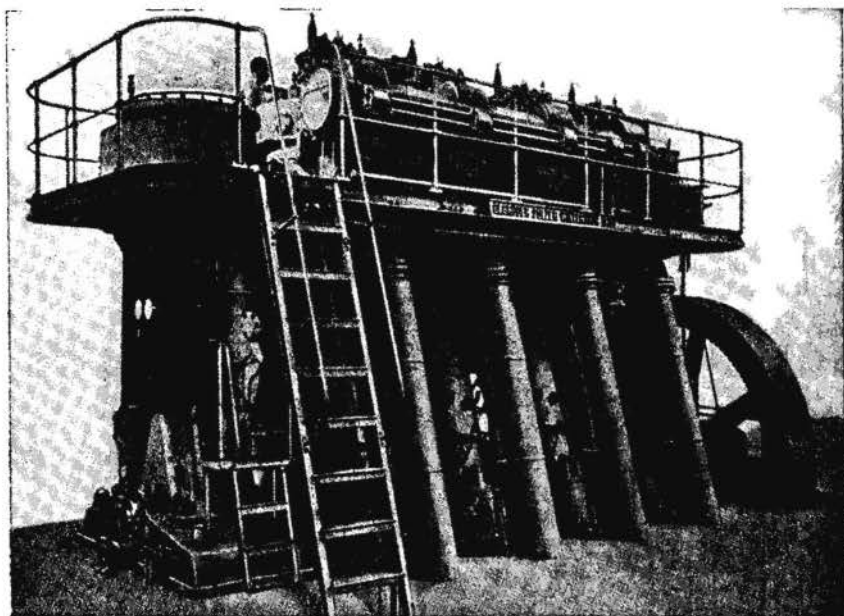
Фиг. 244. Двухтактный двигатель Зульцер, N_e = 2400 л. с.
