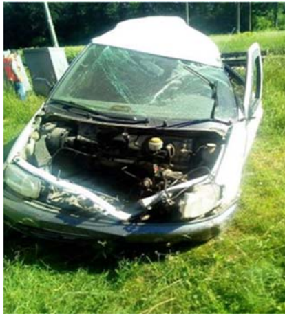
Рисунок 7 – Наслідки зіткнення пасажирського електровоза з мікроавтобусом на швидкості 115 км/год.
