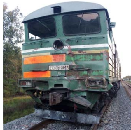
Рисунок 8 – Наслідки зіткнення вантажного електровоза з вантажним автомобілем
