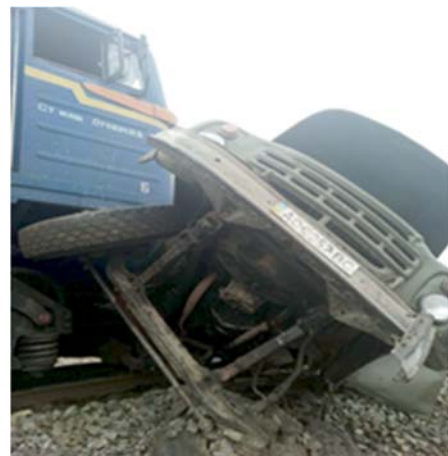
Рисунок 4 – Наслідки зіткнення тепловоза серії М62 з вантажним автомобілем ЗІЛ.
