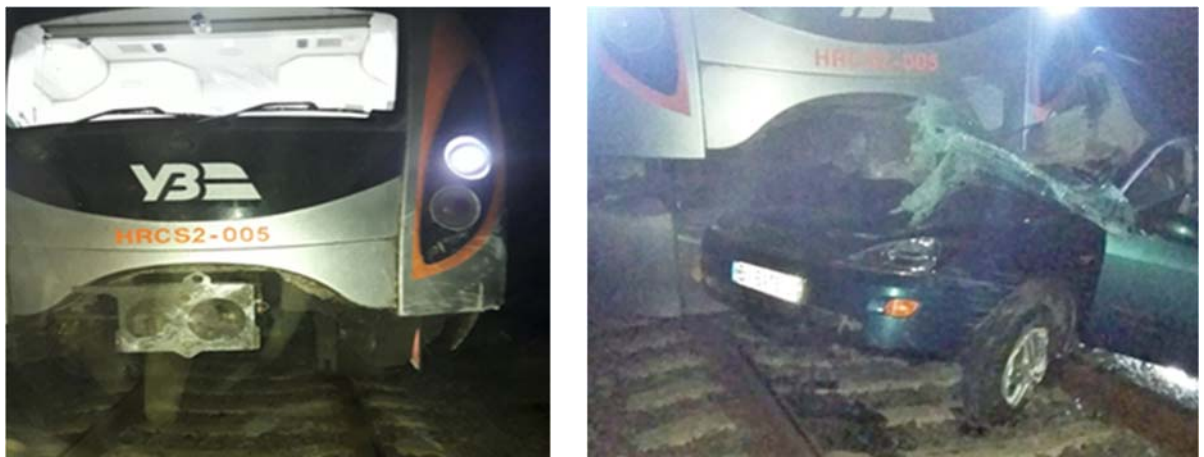
Рисунок 6 – Наслідки зіткнення швидкісного електропоїзда Hyundai Rothem з легковим автомобілем.
