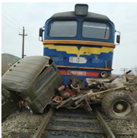
Рисунок 4 – Наслідки зіткнення тепловоза серії М62 з вантажним автомобілем ЗІЛ.
