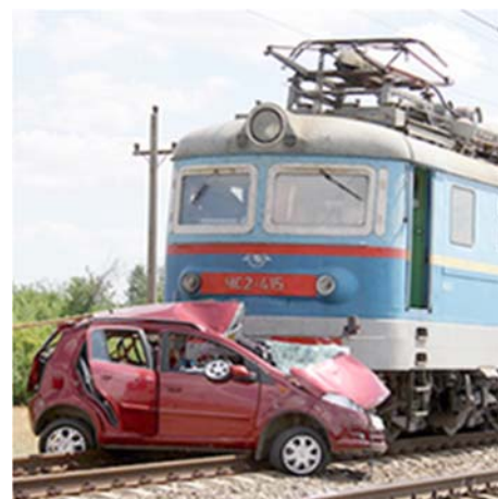
Рисунок 10 – Наслідки зіткнення пасажирського електровоза з легковим автомобілем
