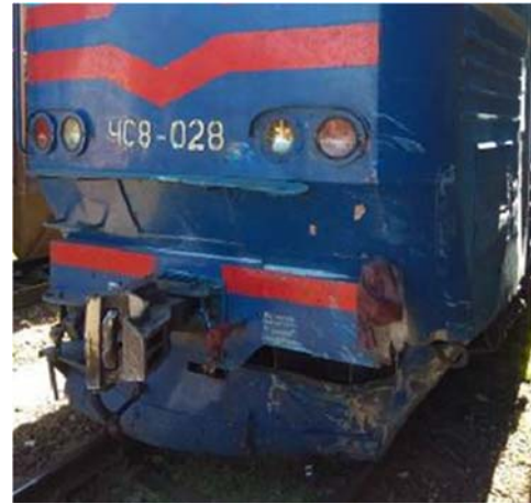
Рисунок 7 – Наслідки зіткнення пасажирського електровоза з мікроавтобусом на швидкості 115 км/год.
